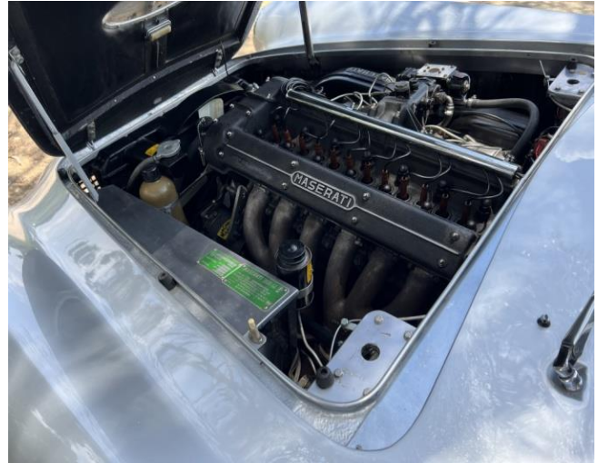
Maserati, 3500 GTI 1963 : protection correcte de la tôle support de capot par un « U » d'aluminium. Mêmes supports de capot vissés que sur Ferrari.
