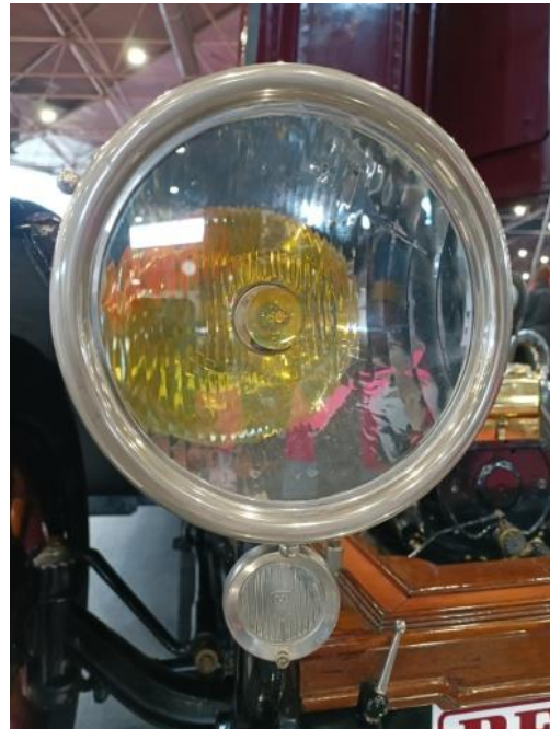
(Photo R-L B-F) Adjonction d'un feu de changement de direction Marchal de 1930, sur une Renault de 1921 (voir support d'adaptation « fait maison » accepté)
