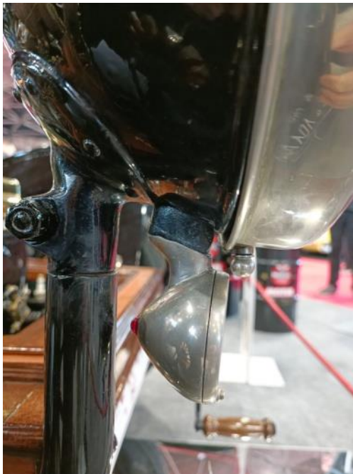
(Photo R-L B-F) Adjonction d'un feu de changement de direction Marchal de 1930, sur une Renault de 1921 (voir support d'adaptation « fait maison » accepté)
