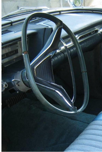
Volant « carré » d'une Imperial 1961 Rétreint de la matière plastique du cercle, âme de métal apparente
