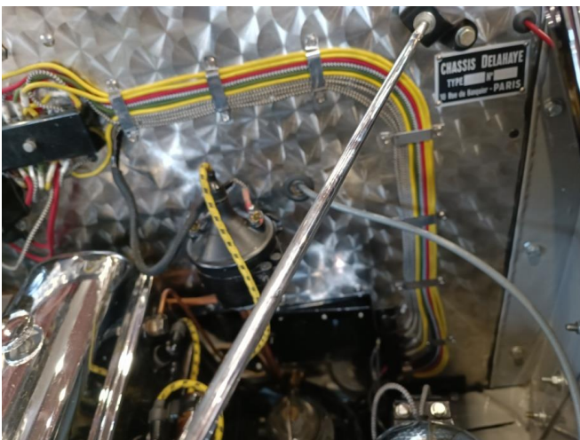
Delahaye 1948 : faisceau électrique bien rangé : les fils électriques modernes, gainés de coton de couleurs différentes, sont acceptés (voir photo page 63) ainsi que les fils de bougie gainés de matière plastique transparente. Mais, certaines jonctions cosse-fils sont incorrectes, sanctionner. De même, le pare-feu recouvert d'aluminium au bouchonnage industriel trop large doit être refusé.
