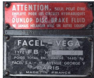
Frappée et rivetée (rivets pleins)
