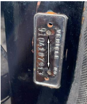
Chrysler, plaque repoussée, frappée et soudée par points
