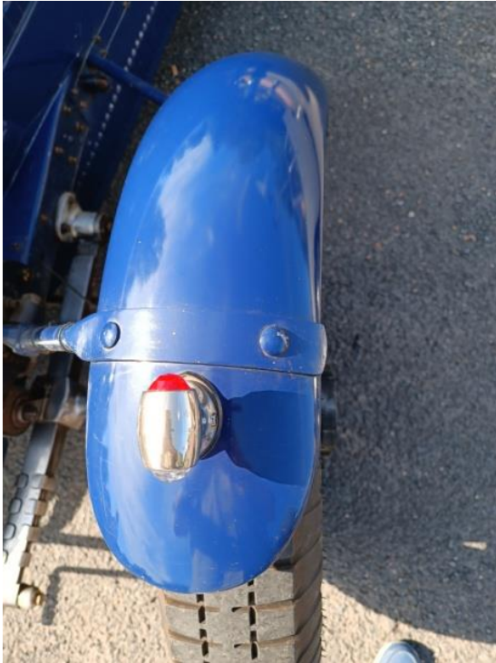
Photos R-L B-F : Tête de « rivet » d'aile de Bugatti : noyée dans la peinture
