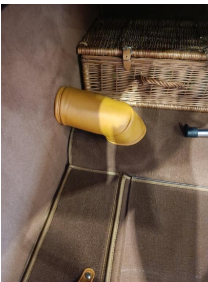
Delahaye 1948 : coffre encombré, moquette nylon, goulotte d'essence revêtue de cuir (restauration excessive)
