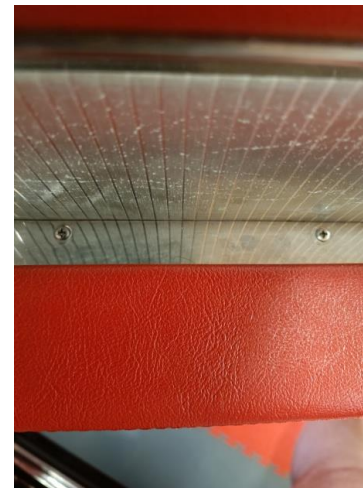
Rectification effectuée : accouoir avec ses 2 vis correctes
