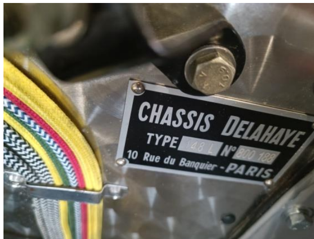
(Photo R-L B-F) Delahaye 148 L, 1948. Vis de tirant de capot moderne cadmiée, non vieillie (indices apparents). Modernes aussi, les fils électriques gainés de coton de couleur sont acceptés. Noter la pose de la plaque constructeur correctement rivetée, mais chiffres frappés et non repoussés...
