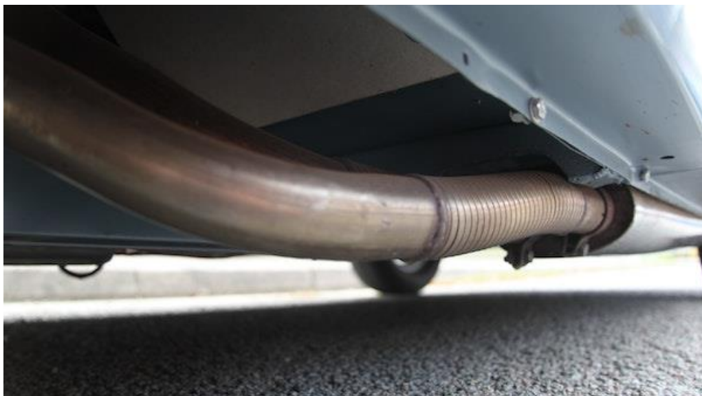
Sortie annelée de la tubulure principale d'une Austin-Healey 1958
