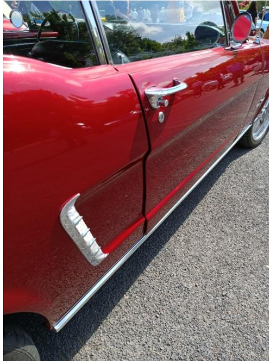
(Photo R-L B-F) Mustang : défaut d'alignement de la porte passager
