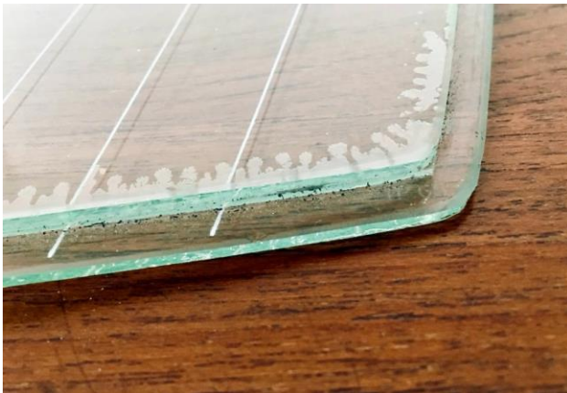
Amorce du phénomène de délaminage par les bords ancienne
