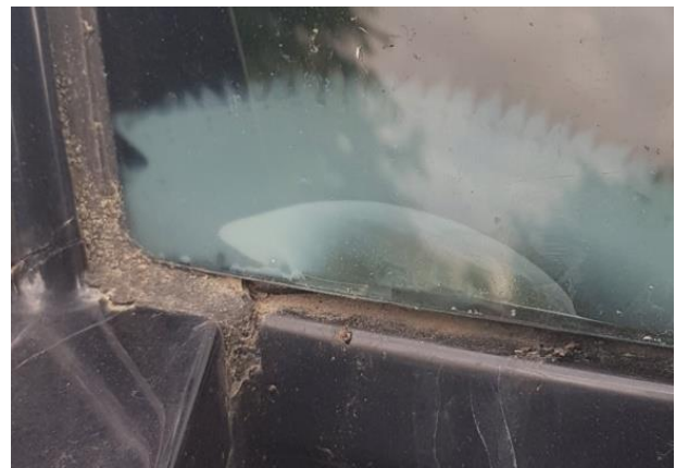
Délaminage sur un pare-brise de voiture an-
