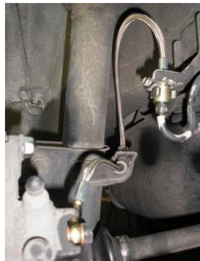
Remplacement par un flexible type aviation
