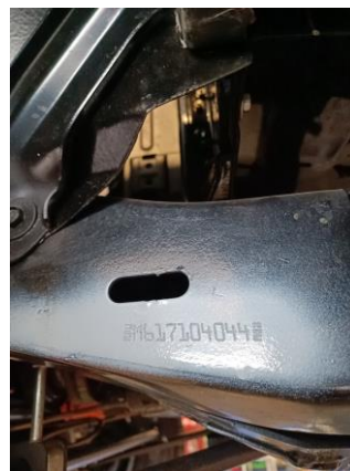
Frappe à froid d'un châssis
