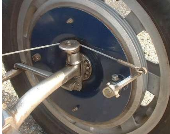
Bugatti : freinage à câble sur tambour
