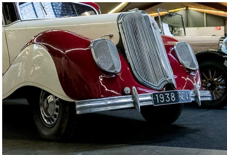
Panhard Dynamique : Superbe travail de carrosserie et de peinture, mais pare-chocs tombant et second enjoliveur chromé (voile de roue ajouré) alors qu'il devrait être peint de la couleur de la tombée de l'aile.
