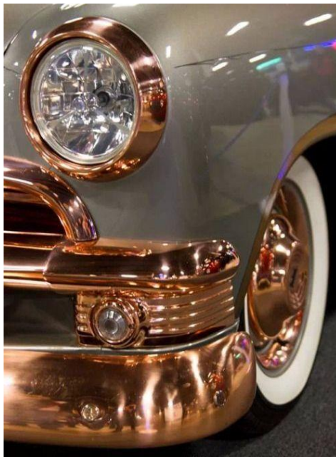
Avivage du dépôt de cuivre avant nickelage, puis chromage.
