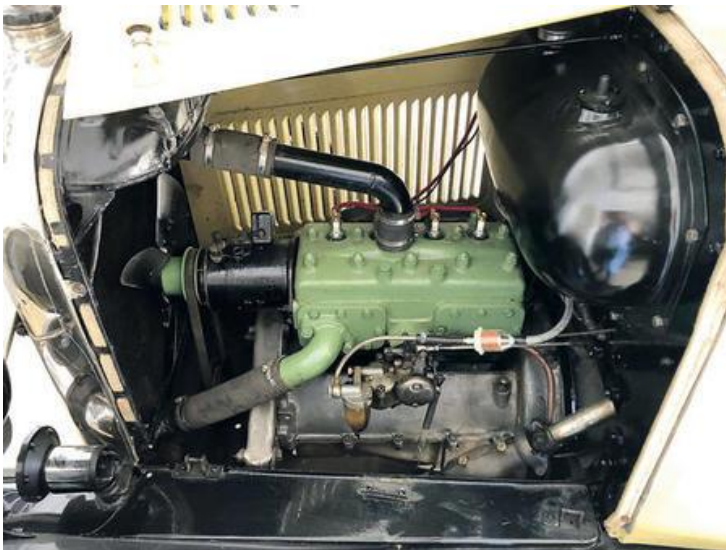
Citroën B14 : outre les défauts inhérents à de une restauration approximative, la tresse de capot est ici maintenue par des passants côté radiateur, par des rivets côté auvent... Par ailleurs, les colliers de durite sont incorrects.
